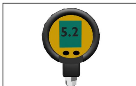
Prilikom ugradnje tlačnog sustava, izvršite ispitivanje izdržljivosti/tlačno ispitivanje kako biste potvrdili cjelovitost sustava cjevovodna.
