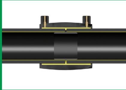
Cijevi treba rezati pod pravim kutom kako bi bile ispravno smještene u spojnici za zavarivanje.
