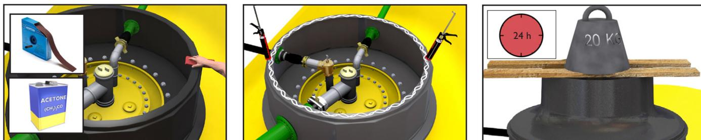
Pripremite spojna područja tako da ih izbrusite brusnim papirom i očistite acetonom prije primjene brtvila. Vrijeme mirovanja brtvila je 24 sata pri 20°C, moguće su varijacije ovisno o temperaturi i vlazi. Tijekom vremena mirovanja potrebno je primijeniti tlak od 20 kg. Za bušenje otvora za ulaz cijevi preporučuju se specijalne GRP ubodne pile. Mogu se koristiti i obične ubodne pile, ali se brže troše.
