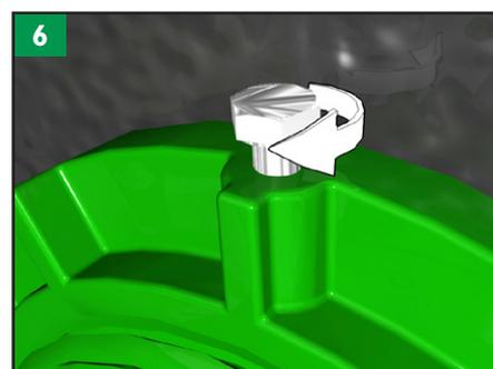
Stegnite vijak za blokiranje za učvršćivanje ulazne brtve.
