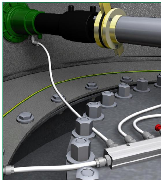
Uređaj za kontrolu nepropusnosti treba biti spojen na KP T ili KP TM.
