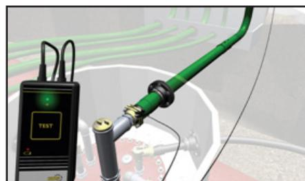
Prilikom uporabe KPS provodljivih cijevi, izvršite sva odgovarajuća ispitivanja provodljivosti (prije i nakon svakog vara) i uvjerite se da je sustav pravilno uzemljen.
