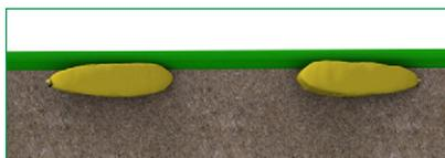
Ako se cijevi ne mogu izravno položiti na podlogu, treba koristiti vreće s pijeskom za potporu cijevi u malim intervalima.
