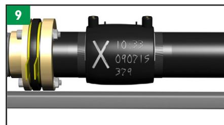
Provjerite da se cijev i prilagodni priključak nisu pomakli tijekom zavarivanja. Provjerite jesu li indikatori zavarivanja vani.
