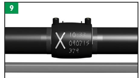
Provjerite da se cijevi nisu pomakle tijekom zavarivanja. Provjerite jesu li indikatori zavarivanja vani.
