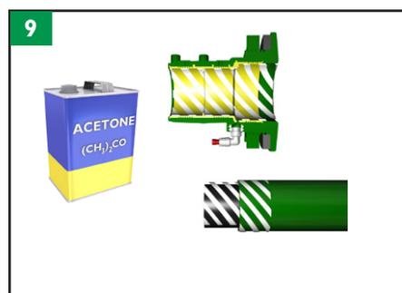
Acetonom ili izopropanolom očistite ostrugana područja na cijevi i unutar završnog cijevnog priključka.
