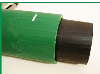
Ispravno ostrugane cijevi. Oksid je uklonjen sa cijelog područja koje će se zavarivati.
