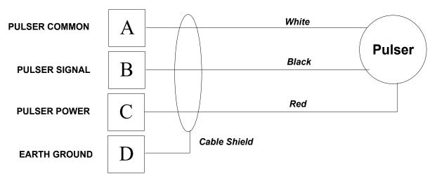
Figure 10: Pulser Wiring -- Veeder-Root 767191
