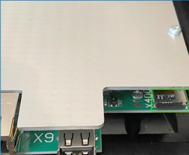
La ilustración anterior muestra la ubicación de la tarjeta Micro SD. La tarjeta SD contiene el sistema operativo, el firmware, la configuración y un historial de la consola.
