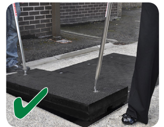
Bezpieczna technika przesuwania przy użyciu rączki Fibrelite.
