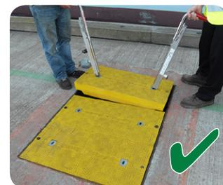
Sichere und schnelle, manuelle Handhabung mit der Fibrelite Aushebe- & Bedienungseinheit
