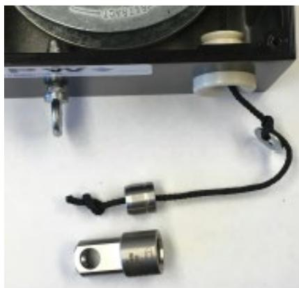
9. Enfillez le câble dans l'ouverture du HRB-1000 ou du raccord rectangulaire en plastique.
