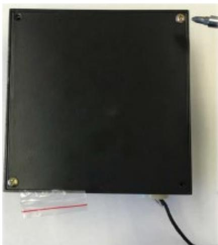
1. Retirez (et conservez pour une utilisation ultérieure) les deux vis qui maintiennent le couvercle métallique sur le boîtier du rétracteur.
