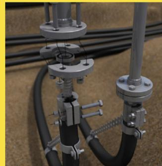
Flanschanschluss. Das Rohr wird vor Ort mit dem Biegegerät um 90 Grad abgewinkelt, um vertikale Durchführungen unterhalb von Behälter oder Zapfsäule zu erzeugen.
