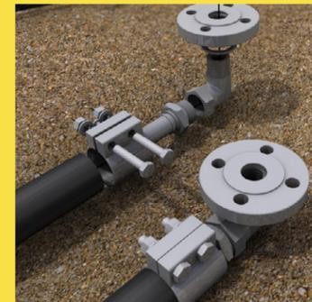
Knie aus rostfreiem Stahl für horizontale Durchführungen unter Behältern oder Zapfsäulen. Übergang mit 90-Grad-Knie aus rostfreiem Stahl oder direkt am Gewindeinsatz.
