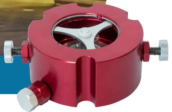
Las válvulas de retención bajo surtidor con brida **OPW 16UP-F** se instalan debajo de los surtidores en los sistemas de aspiración para permitir pruebas fáciles y seguras, así como un aislamiento fiable de las líneas de aspiración en instalaciones nuevas o reacondicionamientos. Además, se pueden instalar con un personal mínimo y sin interrupción del funcionamiento de la estación.
