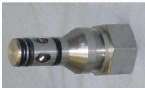
Rys 4. “O-ringi” modułu zrywnego zaworu
