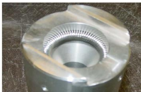
Rys 5. Umieszczenie sprężyny zaciskowej
