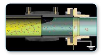
Wenn niedrig leitender Kraftstoff durch ein nicht leitendes Rohr fließt, wird statische Elektrizität erzeugt. Der Kraftstoff wird positiv geladen und die Rohrwand wird negativ geladen.
