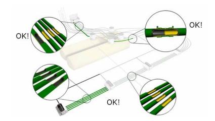
Wenn an einer Tankstelle nicht leitende durch leitende Rohre ersetzt werden, erhöht dies die elektrostatische Sicherheit, selbst wenn nur ein Teil des Rohrleitungssystems leitend ist.
