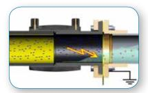
Zwischen negativ geladenem Rohr und positiv geladenem Kraftstoff.
