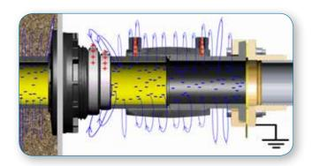
Die statische Aufladung im Rohr erzeugt ein elektrostatisches Feld, das bei leitfähigen Objekten eine Ladung induziert.
