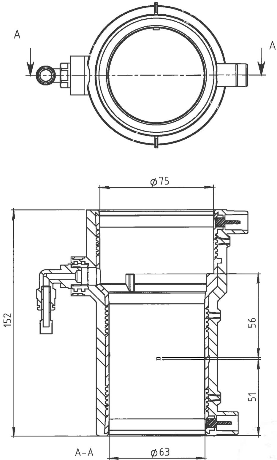
Doppelwandiges Rohrleitungssystem aus Kunststoff zur unterirdischen Verlegung in Tankstellen
