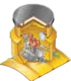
S8SB-390    | Chambre à base solide avec corbeille scellée, couvercle interne, jupe réglable, couvercle interne non structurel et tampon scellé plat rond de 900 mm avec cadre.                                                              | 1,2   |
