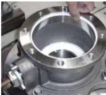
Figure 16 - Instalación del sello del cuerpo
