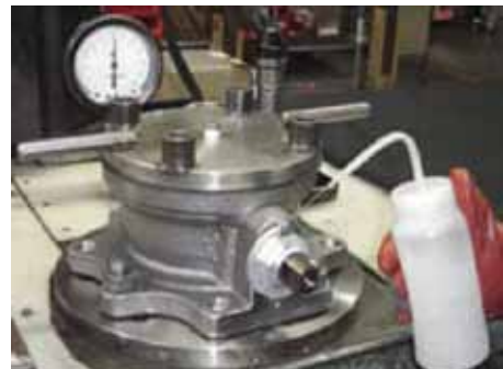
Figura 14 - Prueba de fuga en el vástago de la válvula.
