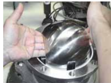
Figure 18 - Colocando la bola de la válvula
