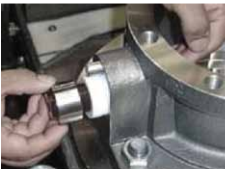
Figura 12 - Instalando el empaque y espaciador Esto es normal.
