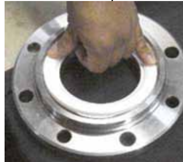
Figure 19 - Instalando el sello de bola en la tapa
