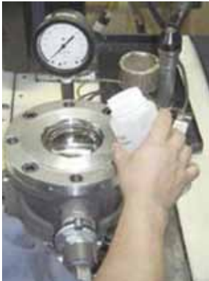
Figura 24 - Inmersión del sello para prueba de sellado
