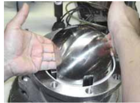
Figura 6 - Remoción de la Bola de la Válvula
