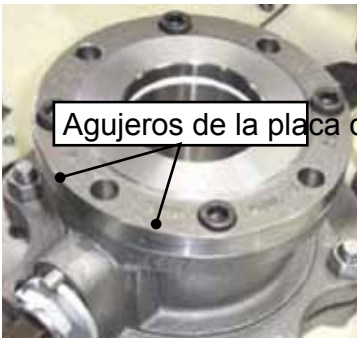
Figura 21 - Orientación de los agujeros de la placa de identificación
