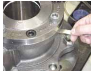
Figura 23 - Revisando el contacto entre la válvula y el cuerpo
