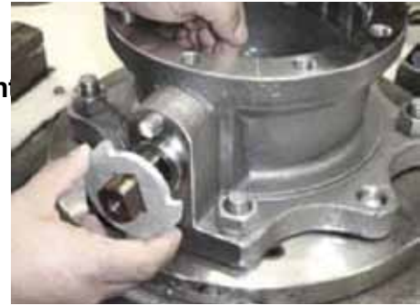
Figura 13 - Instalación de la placa tope
