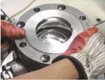
Figura 20 - Colocando la tapa en el cuerpo
