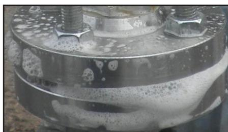
Realizar un test de estanqueidad con solución jabonosa antes de proceder al recubrimiento.
