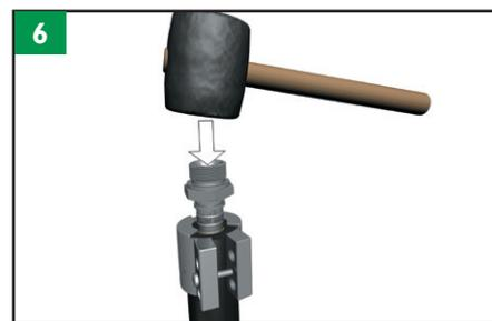
Utilizar un mazo de goma para golpear la inserción KP LPG10-AS-NPT o la KP LPG10-B5 para introducirlas completamente en el tubo.
