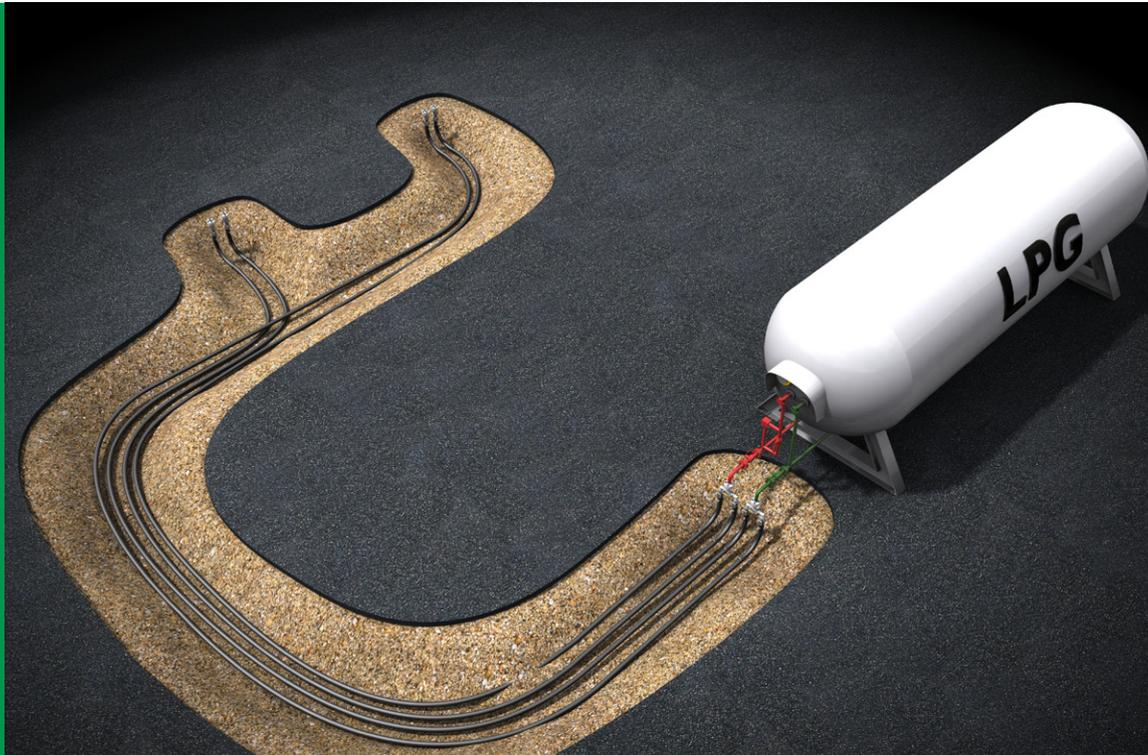
A partir del tanque salen las líneas que alimentan el GLP hasta cada surtidor. Paralelamente con la línea de producto hay un tubo de retorno por el que el vapor de GLP procedente de las operaciones de llenado vuelve al tanque. Estas tuberías generalmente son múltiples en caso de que haya más de un surtidor.
