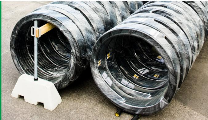
Si los rollos se almacenan en posición vertical necesitan apoyos para evitar la deformación de los tubos.
