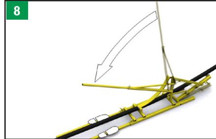
Colocarse con el pie sobre las guías en cada del tubo y tirar lentamente del mango para empezar a doblar el tubo.
