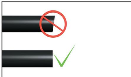
Los tubos han de cortarse en ángulo recto para adaptarse al acoplamiento de compresión LPG10S.
