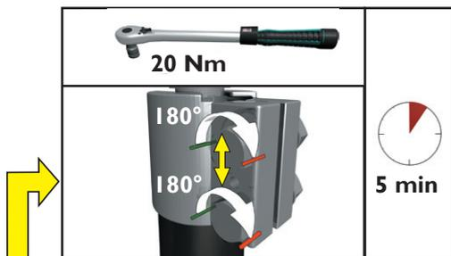
Utilizar una llave dinamométrica para apretar por etapas el acoplamiento LPG10S:
