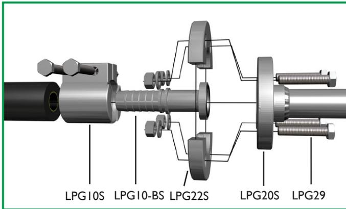
Ensamblaje para transición mediante brida soldable.
