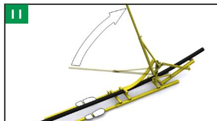
Colocarse sobre las guías y tirar lentamente del mango hasta que la herramienta de doblar se introduce en la muesca siguiente con un clic.
