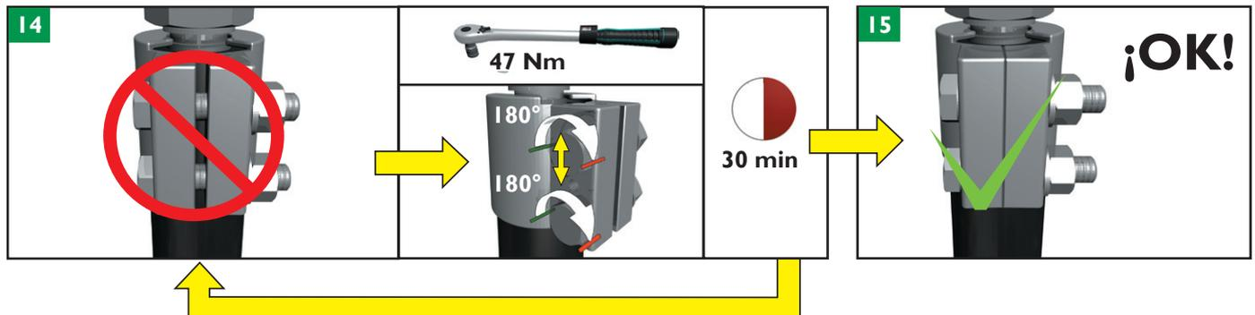
Ajustar la llave dinamométrica a 47 Nm. Apretar los pernos en forma alternativa, media vuelta cada uno, hasta 47 Nm.
