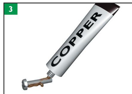
Lubricar el tubo de montaje pequeño con pasta de cobre, pasta cerámica o MoS<sub>2</sub>.
