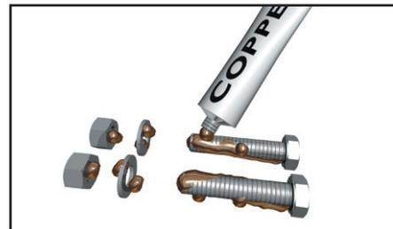
Lubricar los pernos de acero inoxidable, arandelas y tuercas con pasta de cobre, pasta cerámica o con MoS<sub>2</sub>.
