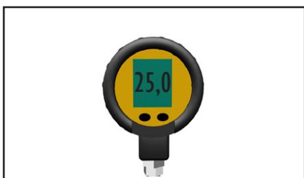
Someter el tubo a una prueba de 25 bares de presión (363 psi) o según las disposiciones locales, pero como máximo a 40 bares (580 psi).
