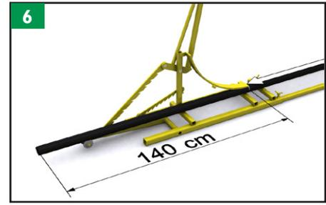
Colocar el tubo de manera que sobresalga por lo menos 1,4 metro desde el borde de la curva. Esto proporciona una curva adecuada para el enterramiento del tubo a 60 cm. Si se precisan profundidades más grandes, ajustar lo que convenga la posición del tubo.
