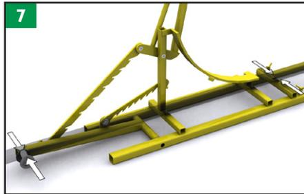
Asegurarse de que el tubo descansa sobre la ruedecilla del rodillo y entre los dos talones de la parte posterior de la herramienta de doblar.
