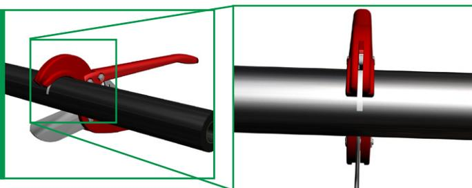
Para cortar tubos GLP de KPS puede utilizarse la tijera para tubos.
