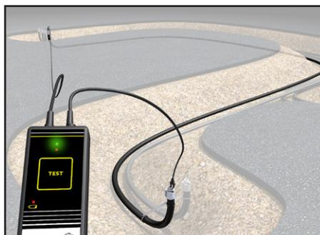
Medir la conductividad cuando estén montados los acoplamientos LPG10S y LPG10-AS-NPT o el LPG10-BS.
