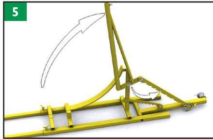
Levantar el mango y poner el fiador grande en la posición de arranque con el pasador de cierre en la primera muesca.
