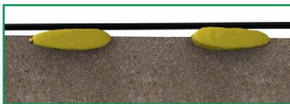
*Si no se pueden colocar directamente las tuberías en el lecho, es conveniente utilizar sacos con arena como soporte para las tuberías a intervalos cortos.*
