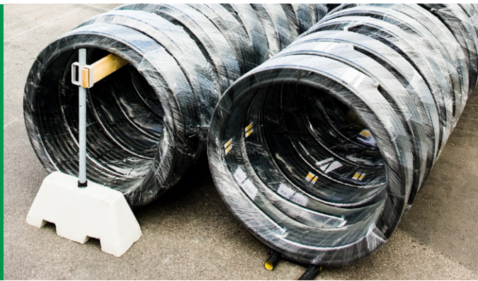
Zwoje przechowywane w pozycji pionowej muszą być podparte w celu uniknięcia odkształcenia rury.
