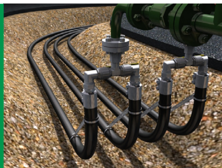
Verzweigen von LPG-Leitungen.
