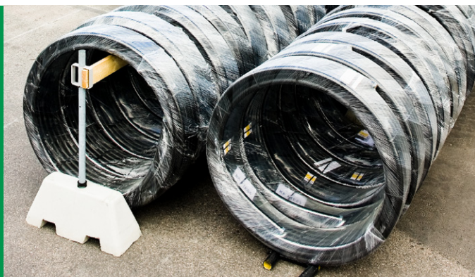
Werden Rollen aufrecht gelagert, müssen sie gestützt werden, um Deformationen des Rohrs zu vermeiden.
