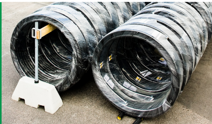
Kad kolute cijevi skladištite u uspravnom položaju, potrebno ih je poduprijeti kako bi se izbjegla izobličenja cijevi.
