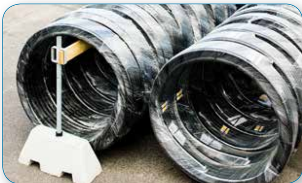
Si los rollos se almacenan en posición vertical necesitan apoyos para evitar la deformación de los tubos.
