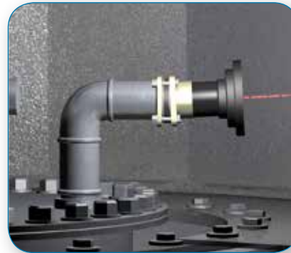
Colocar el indicador láser en la terminación roscada montada sobre la tapa de acceso.
