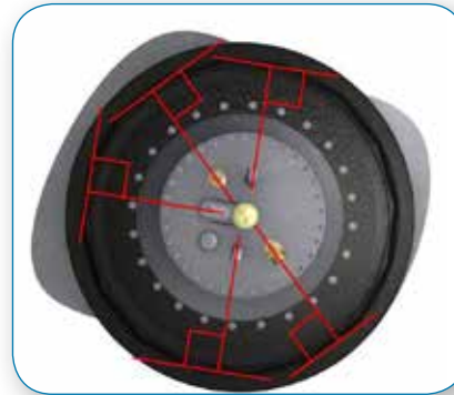
Comprobar que los tubos están en ángulo recto respecto a la pared de la arqueta y las fijaciones de la tapa de acceso.
