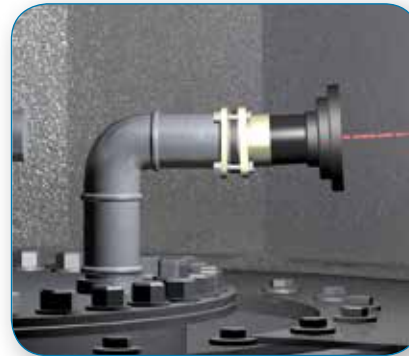
Поместите лазерный указатель в предварительно смонтированные фитинги на крышке люка.
