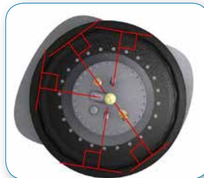
Убедитесь, что трубы находятся под прямым углом к стенке камеры и фитингам на крышке люка.
