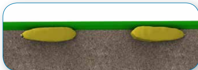
Если трубы невозможно уложить непосредственно на подушку, для опоры трубопровода должны использоваться мешки с песком, расположенные через небольшие интервалы.
