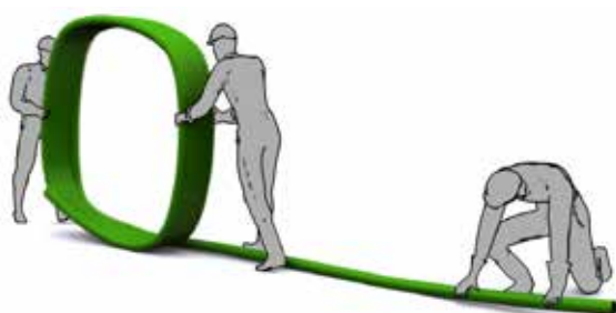
Наилучший и безопасный способ — разматывание трубы с участием трех человек.
