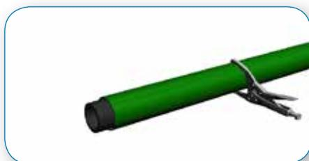
Quando si prepara la saldatura di un tubazione a doppia parete, tenere saldi fra loro il tubo interno ed esterno, prima di inserire il raccordo, usando un morsetto KPS a circa 50 cm dall'estremità della tubazione.
