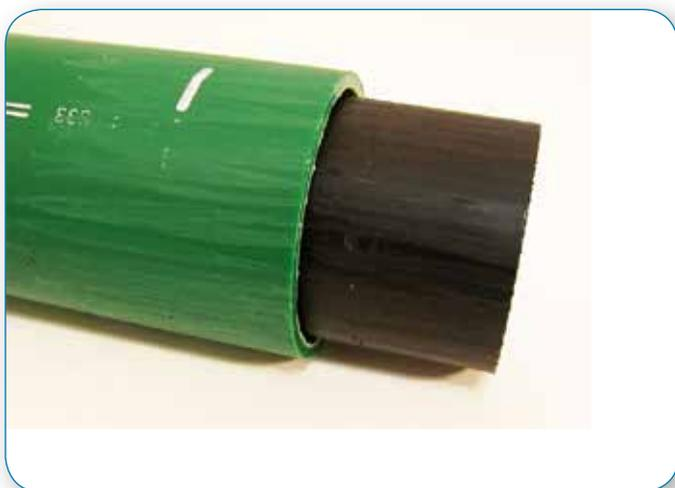
*Raschiatura insufficiente. Non tutte le aree sono state raschiate.*
