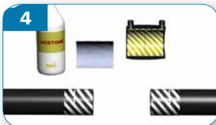
Pulire l'area dei tubi da saldare e l'interno del manicotto di saldatura con acetone o isopropanolo.
