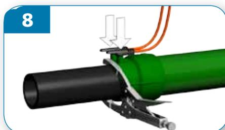
Collegare i cavi di saldatura al manicotto e seguire le istruzioni della saldatrice.
