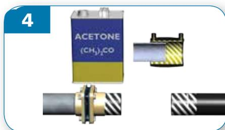
Pulire l'area dei tubi, del raccordo adattatore da saldare e l'interno del manicotto di saldatura con acetone o isopropanolo.
