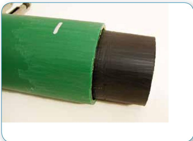
*Tubi raschiati correttamente. L'ossido è stato rimosso dall'intera area da saldare.*
