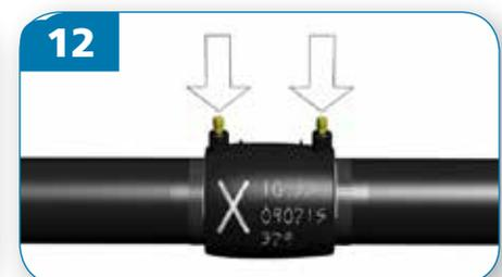
Applicare i cappucci antistatici dopo il test di pressione.
