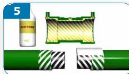
Pulire l'area dei tubi/curve/raccordi a T da saldare e l'interno del manicotto di saldatura con acetone o isopropanolo.
