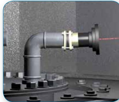
Posizionare il puntatore laser nei raccordi premontati sul coperchio del passo d'uomo.
