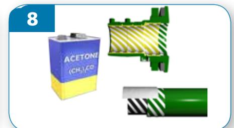
8 Pulire le aree raschiate sul tubo e l'interno del raccordo terminale con acetone o isopropanolo.
