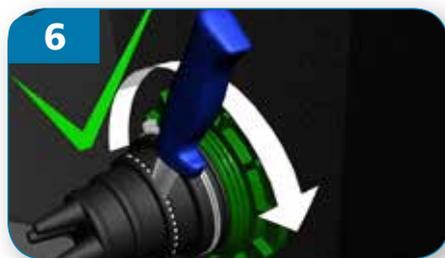
6 Tagliare la guarnizione della cuffia di gomma per calzare il tubo. Se necessario lubrificare il tubo.
