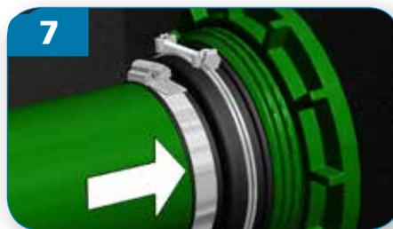
7 Inserire il tubo attraverso la flangia passaparete e la fascetta stringitubo. Realizzare i collegamenti necessari dentro il pozzetto.
