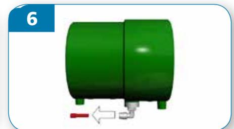
6 Come precauzione, aprire la porta del test del raccordo terminale KP T per evitare che l'aria scaldandosi aumenti la pressione nell'intercapedine durante la saldatura. \*
