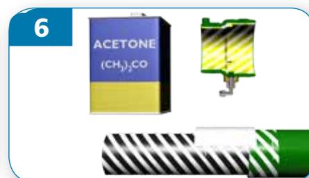
Pulire l'area dei tubi da saldare e l'interno del raccordo terminale con acetone o isopropanolo.
