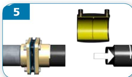
Per i tubi conduttivi inserire un KP-CC nel giunto.
