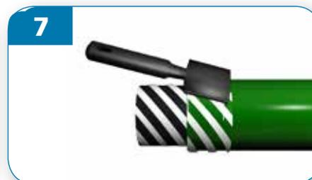
7 Rimuovere lo strato di ossido da tutte le aree da saldare usando un raschietto.
