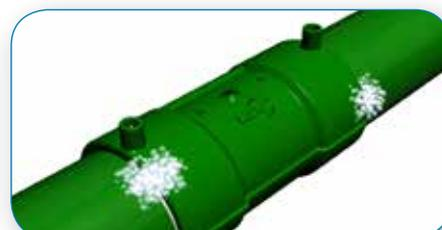
Effettuare il test della tenuta mediante insaponatura prima del riempimento e opzionalmente durante e dopo il riempimento.
