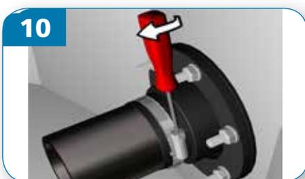
10 Inserire il tubo attraverso la flangia passaparete e la fascetta stringitubo. Realizzare i collegamenti necessari all'interno del pozzetto e serrare.
