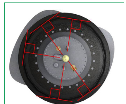
Upewnij się, że rury biegną pod kątem prostym do ścianki studni i armatury na władze zbiornika.
