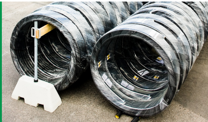
Zwoje przechowywane w pozycji pionowej muszą być podparte w celu uniknięcia odkształceń rury.
