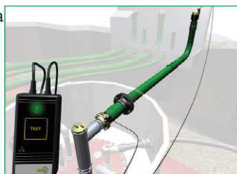
Zawsze na początku i na koniec dnia trzeba przeprowadzić kalibrację testera przewodności.
