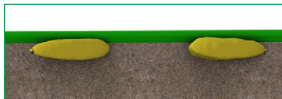
Jeśli nie można położyć rur bezpośrednio na łożu, należy do ich podparcia zastosować worki wypełnione piaskiem, umieszczone w niewielkich odstępach.
