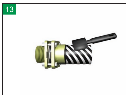
13 使用刮刀去除焊接区域的氧化层。
