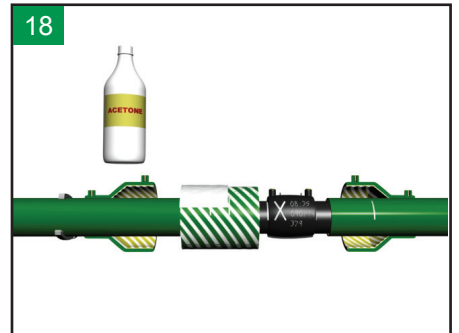
18 使用丙酮或异丙醇清洁变径接头的内部以及 75 mm 和 125 mm 管道。
