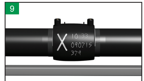
确认管道在焊接过程中没有移动。检查焊接接头上的指示圆柱是否被顶出。
