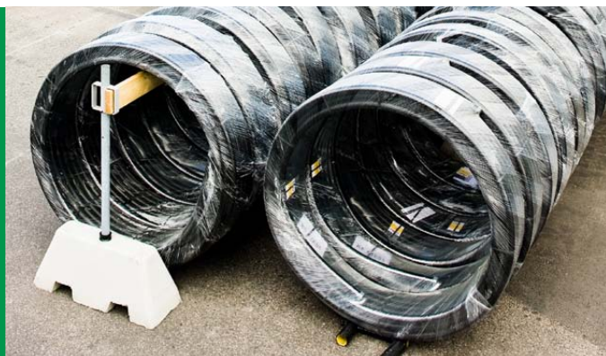
Jos kelat varastoidaan jättämällä pystyasentoon, ne on tuettava putkien muodonmuutoksen välttämiseksi.
