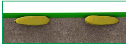
Jos putkia ei voi sijoittaa suoraan pohjapatjan päälle, ne on tuettava hiekkasäkkien avulla riittävän lyhyin välimatkoin.
