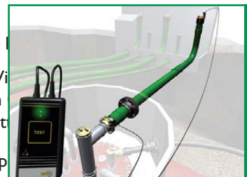
Kalibroi johtavuusmittari joka päivä töiden alkaessa ja päättyessä.
