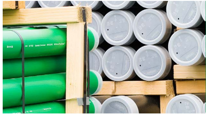
Pätehuiput on pidettävä putkien päissä asennukseen saakka putkien suojaamiseksi UV-säteilyltä ja likaantumislta.
