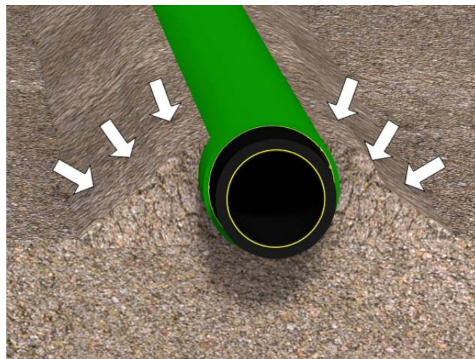
Täytä huolellisesti putkien alapuoliset kohdat.
