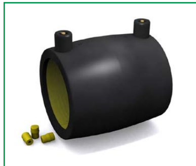
KPS toimittaa suojuksia (antistaattiset tulpat), joita käytetään hitsausmuhvin pinnien eristämiseen staattisen sähkön aiheuttamisen kipinäpurkausten estämiseksi.
